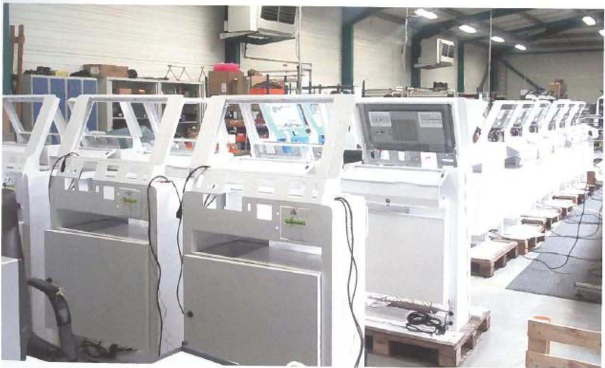
*L'assemblage définitif des bornes se fait en interne sur la base d'éléments fournis par des partenaires industriels.*
